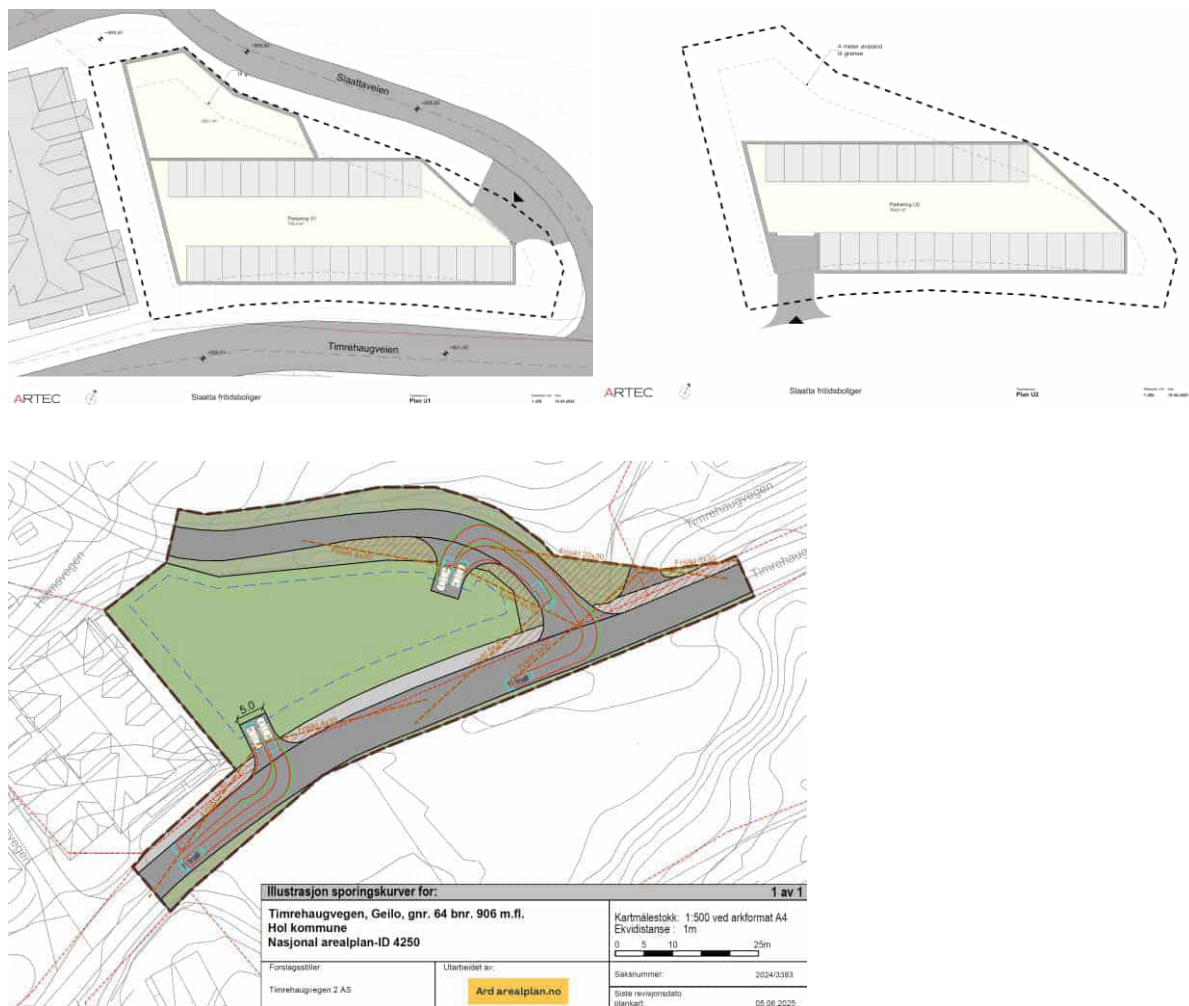
Figur 35: Sporingskurver for inn og utkjøring til garasjekjeller.
