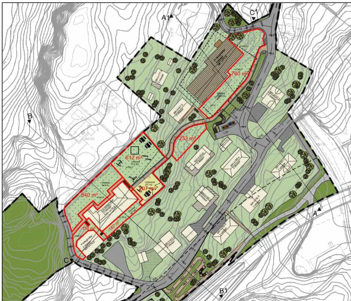
Figur 32: Illustrasjon som syner uteareal som er i samsvar med kvalitetskrava (areal innanfor raud markering).
