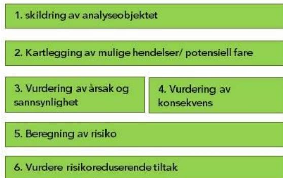
Figur 27 Skjematisk framstilling av metode
